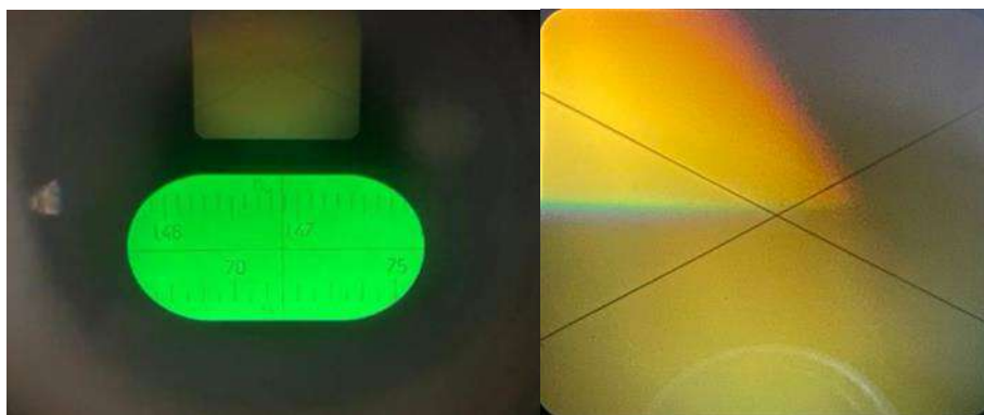
Рисунок 12 (А, Б) – полученные данные при анализе на показатель преломления на рефрактометре
