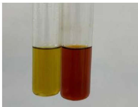
Рисунок 1 - Качественная реакция на флавоны с гидроксидом натрия
