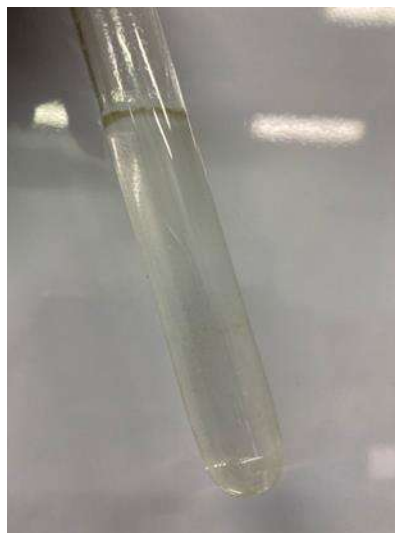
Рисунок 3 – Прозрачный раствор с минимальным количеством жирных капель в процессе определения жирных масел в эфирных маслах
