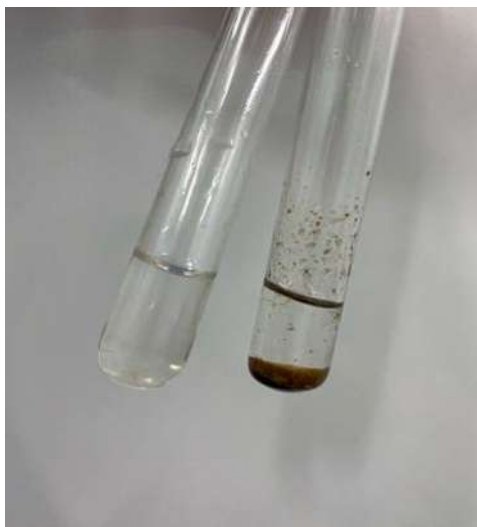
Рисунок 1 – Качественная реакция на \alpha -пинен с KMnO_4
