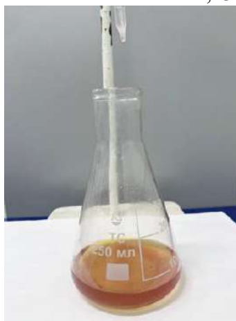
Рисунок 4 – Окрашенный раствор после проведенного титрования калия гидроксидом в процессе определения кислотного числа
